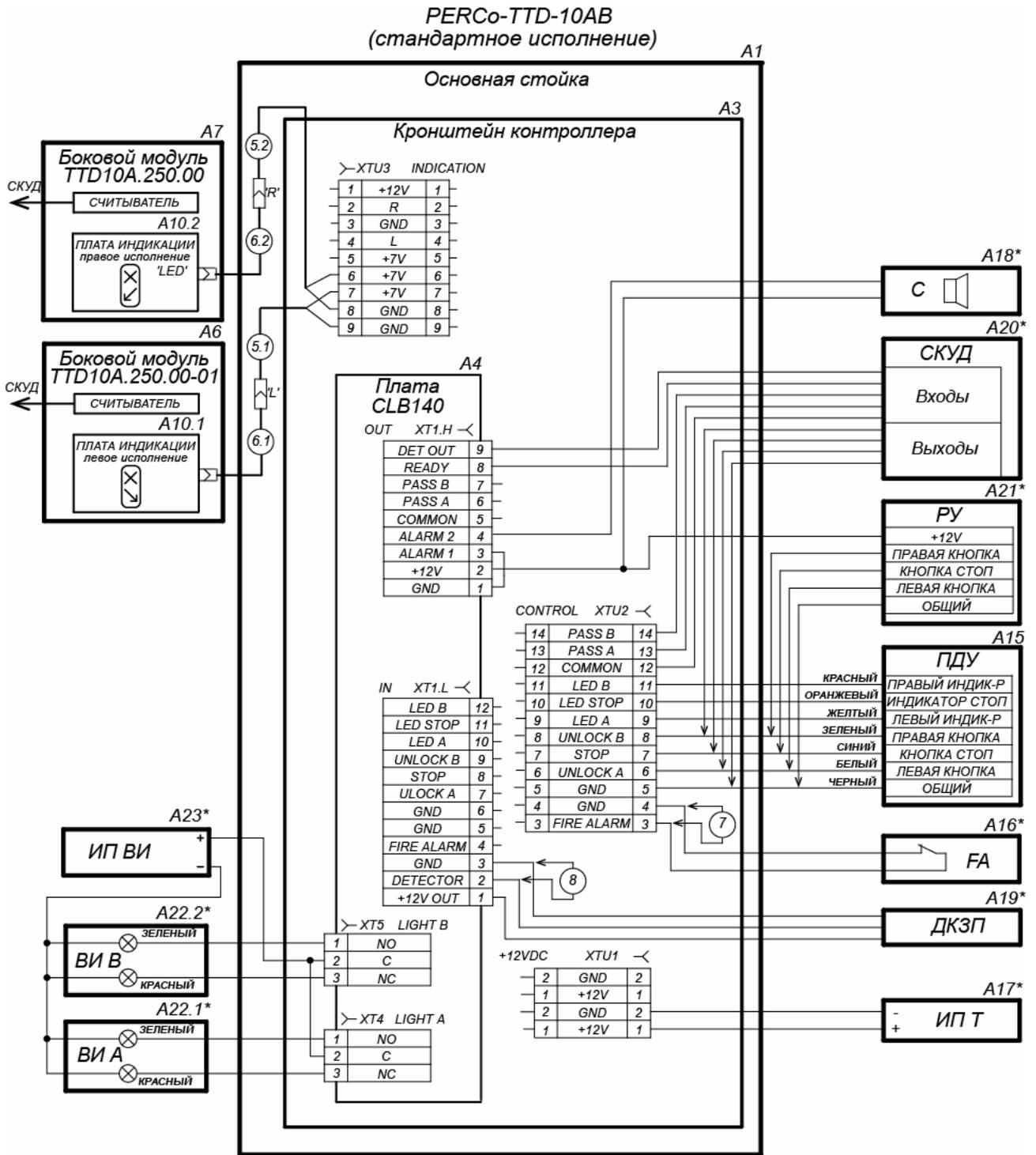
Рисунок 20. Схема соединений турникета и дополнительного оборудования для стандартной модификации PERCo-TTD-10AB<sup>F</sup>
