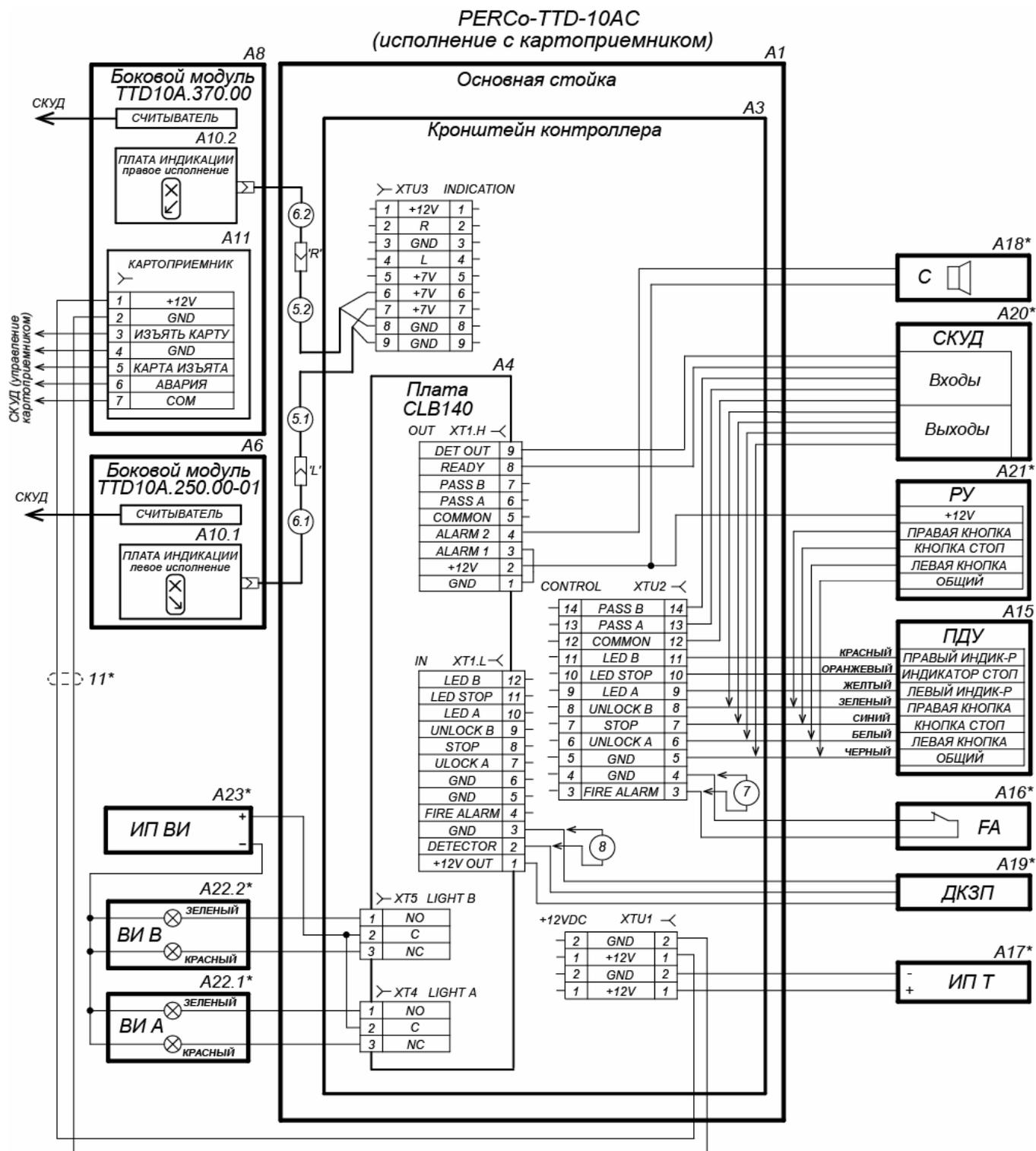
Рисунок 21. Пример схемы соединений турникета и дополнительного оборудования для модификации с картоприемником PERCo-TTD-10AC<sup>1</sup>
