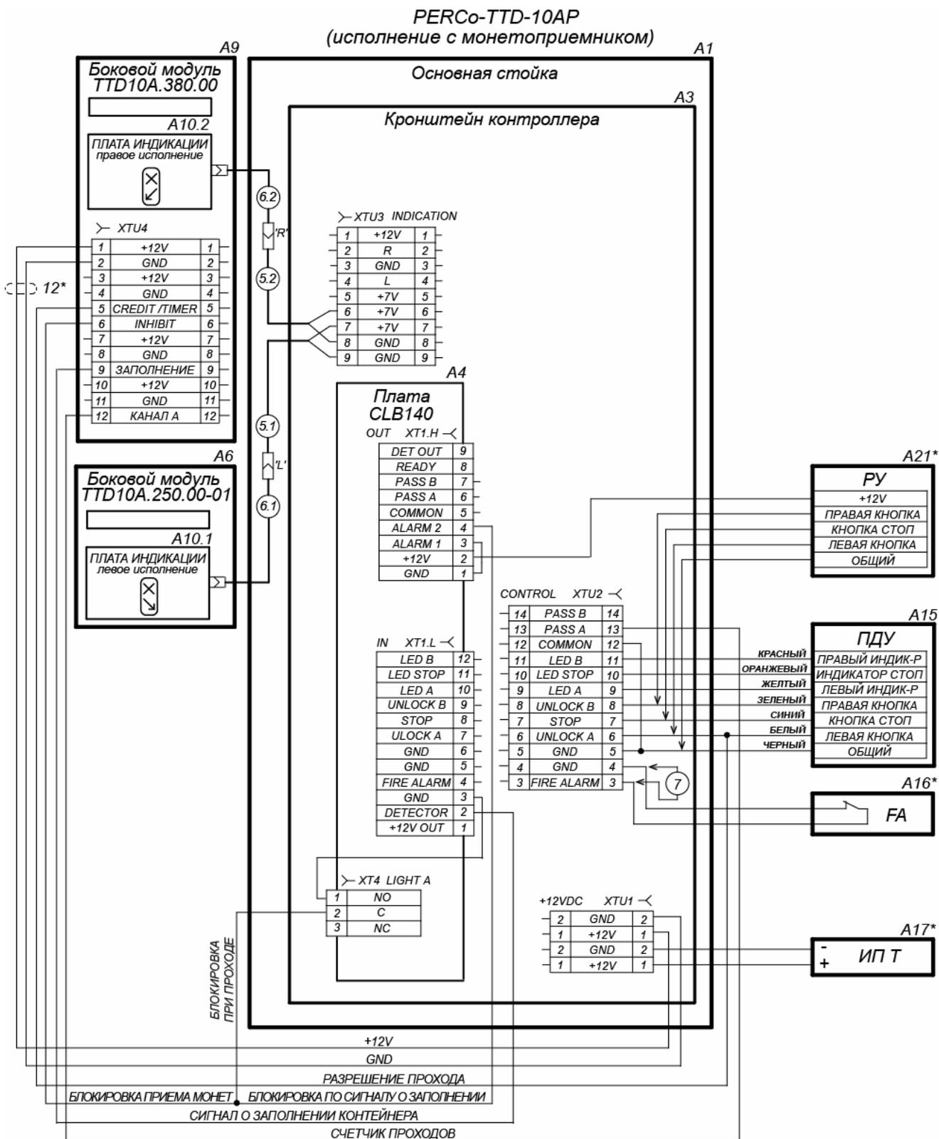
**Рисунок 22. Пример схемы соединений турникета и доп. оборудования для модификаций с монетоприемником PERCo-TTD-10APR, PERCo-TTD-10APE<sup>Ф</sup>**
