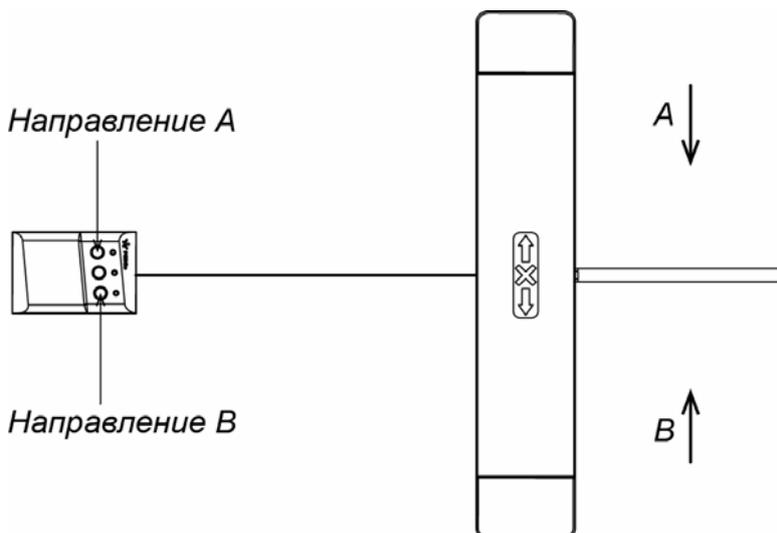
Рисунок 11. Стандартная ориентация ПДУ относительно стойки турникета
