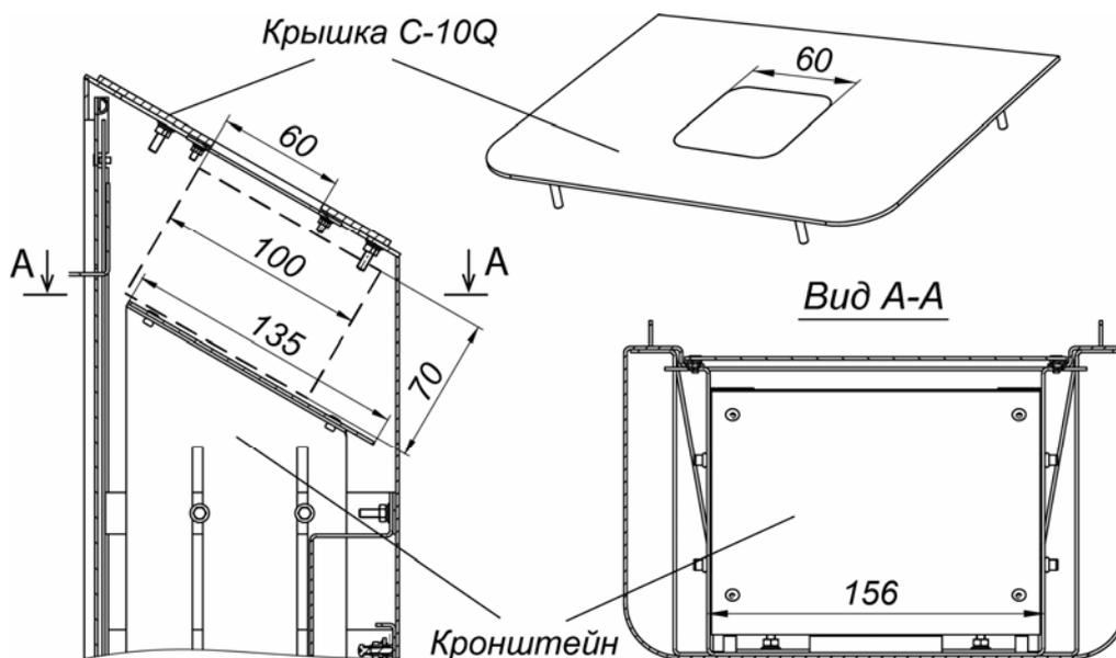
Рисунок 28. Внешний вид боковой крышки **PERCo-C-10Q** и порядок установки сканера штрихкода (пунктиром показаны габариты сканера)
