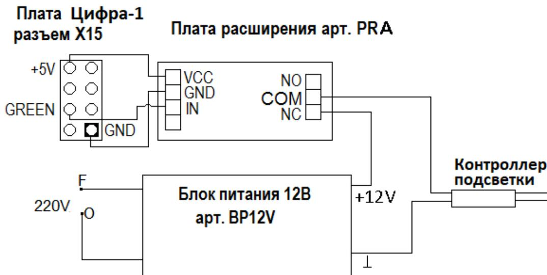
Блок питания рекомендуется устанавливать внутри блока электроники.
