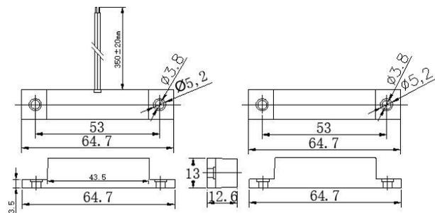
Извещатель магнитоконтактный ST-DM120NC-WT предназначен для контроля положения различных строительных конструкций (дверей, окон, люков, ворот и т.д.). Данное устройство может использоваться в системах охранной сигнализации или контроля и управления доступом.
