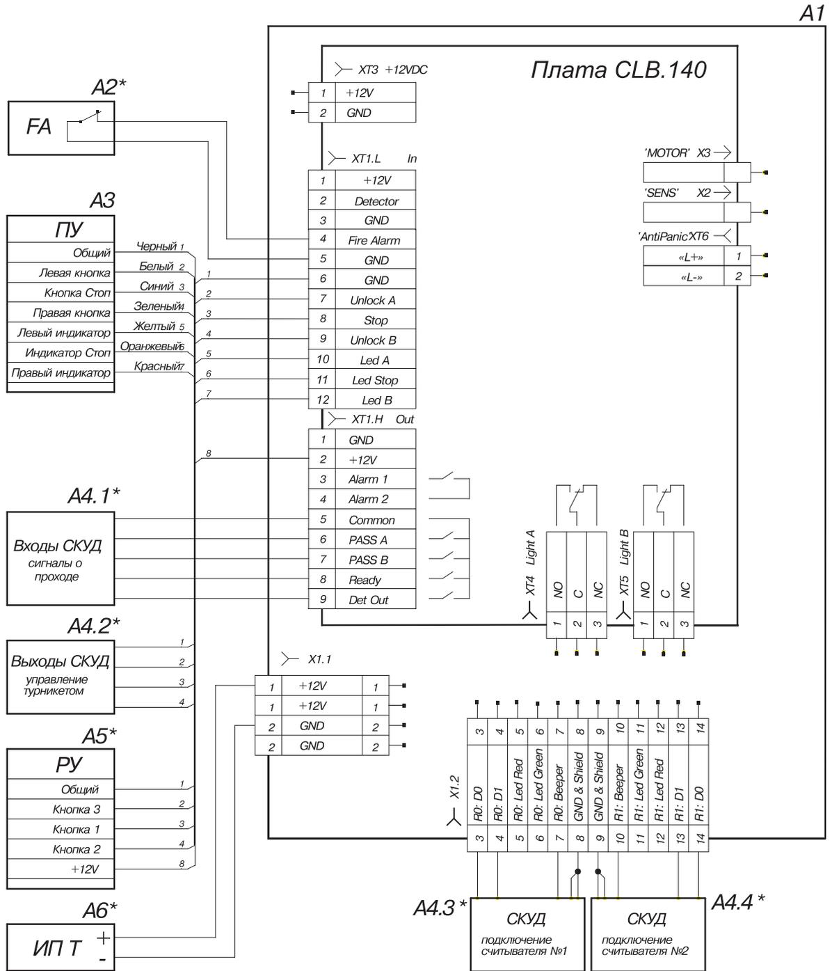
Схема соединений турникета PERCO-TV01.1А и дополнительного оборудования
