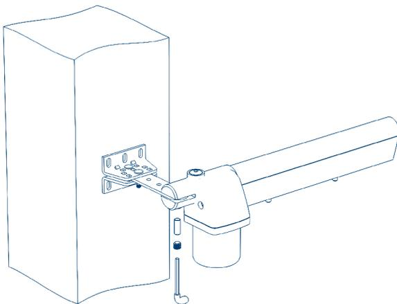
Закрепите привод. Прикрепите основание привода к заднему кронштейну.
