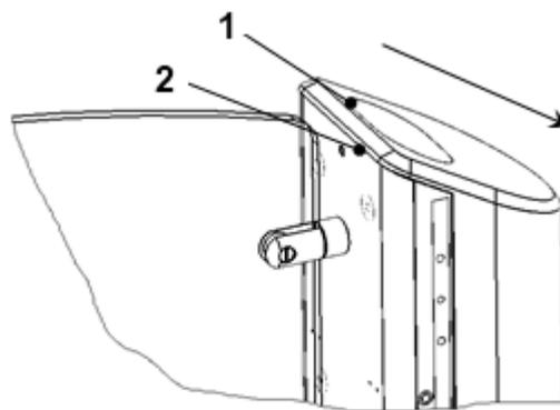
1 - панель индикации; 2 - винт М4
