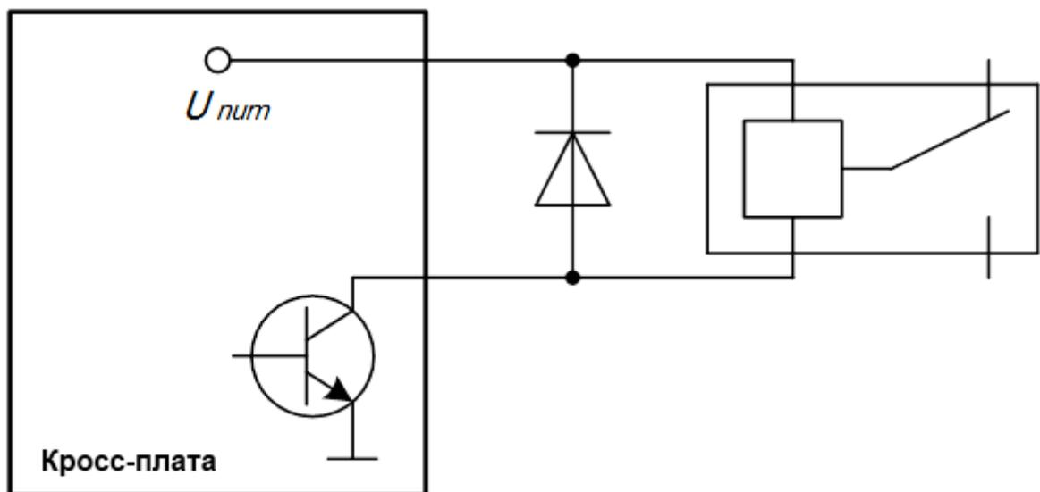
Рисунок 11 – Схема подключения диода параллельно обмотке реле
