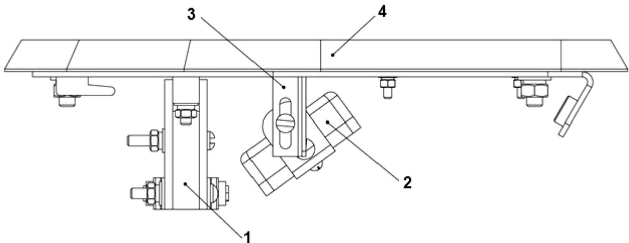
1 - направляющие карт; 2 - считыватель; 3 - кронштейн; 4 - панель индикации
