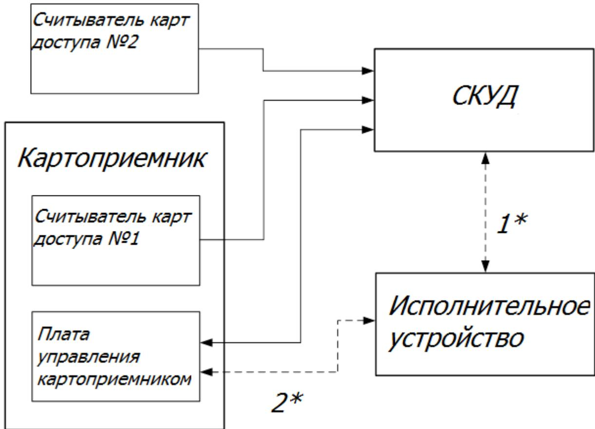
Рисунок 19 – Структурная схема №1
