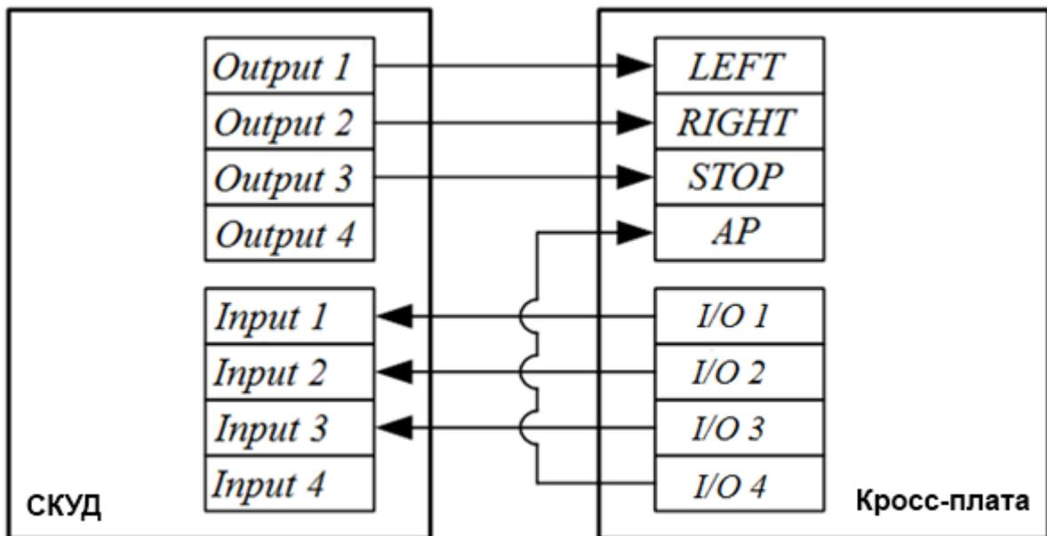
Рисунок 12 – Схема подключения ПУ к контроллеру СКУД
