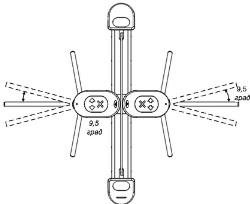
Рисунок 2 – Возможный свободный ход планки в режиме «STOP»
