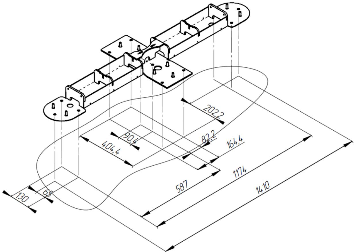
Рисунок 18 – Расположение монтажных отверстий относительно внешних габаритов турникета
