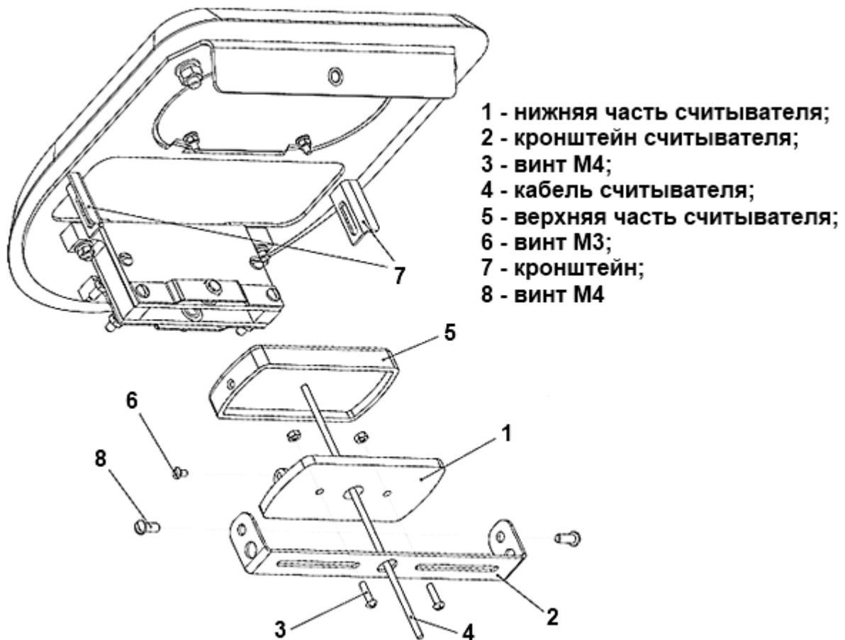
Рисунок 16 – Схема установки считывателя бесконтактных карт
