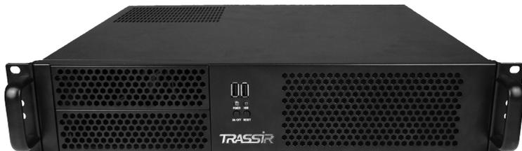
**TRASSIR NeuroStation Compact RE** – сетевой видеорегистратор для IP-видеокамер под управлением TRASSIR OS (Linux) с поддержкой видеоналиктики на основе нейронных сетей: детекция проникновения людей в зону, подсчет количества людей в зоне (например, в очереди), а также поиск в архиве по людям. Поддержка Offload-аналитики (прием и обработка изображений передаваемых с других серверов TRASSIR).
