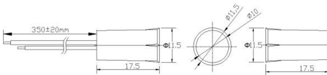
Извещатель магнитоконтактный ST-DM010NC-BR предназначен для контроля положения различных строительных конструкций (дверей, окон, люков, ворот и т.д.). Данное устройство может использоваться в системах охранной сигнализации или контроля и управления доступом.
