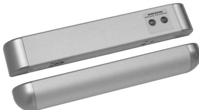
Электромеханический соленоидный замок ST-DB511MLT накладного монтажа предназначен для работы в составе систем контроля доступа с электронным управлением блокировкой дверей. Замок ST-DB511MLT является нормально-открытым, т.е. разблокируются при отключении питания и блокируются при его наличии. Для мониторинга положения створки двери в системе контроля доступа можно использовать соответствующий выход замка.
