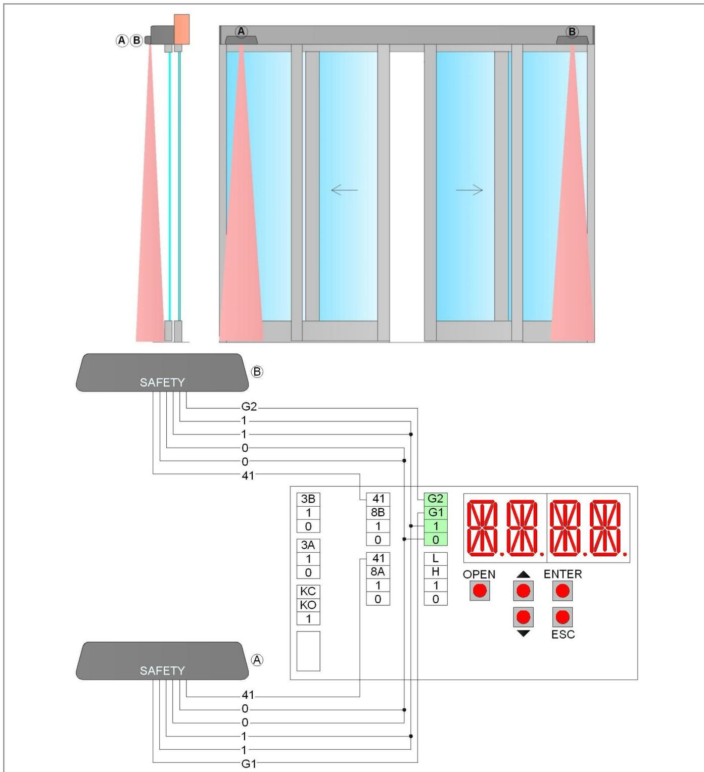
Подключите радар, используя прилагаемый кабель к плате управления, следующим образом:
