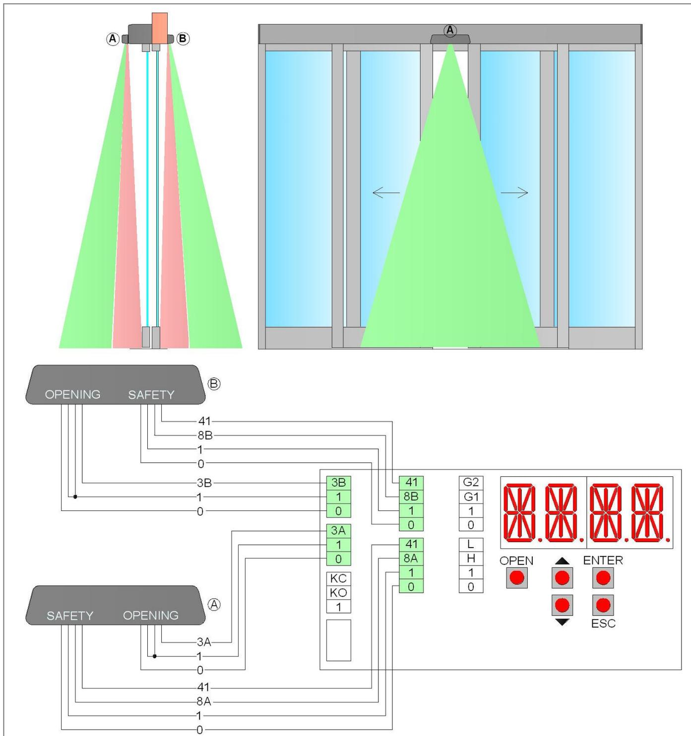
Подключите радары с помощью прилагаемого кабеля к клеммам платы управления следующим образом:
