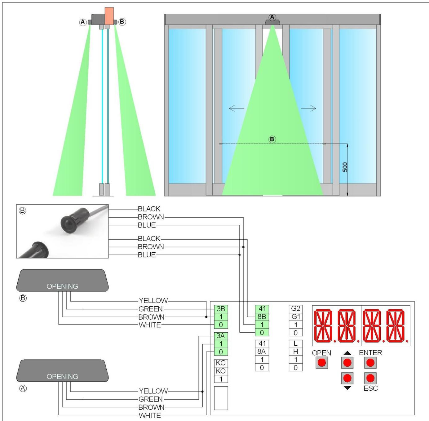
Подключите радары с помощью прилагаемого кабеля к клеммам платы управления следующим образом:
