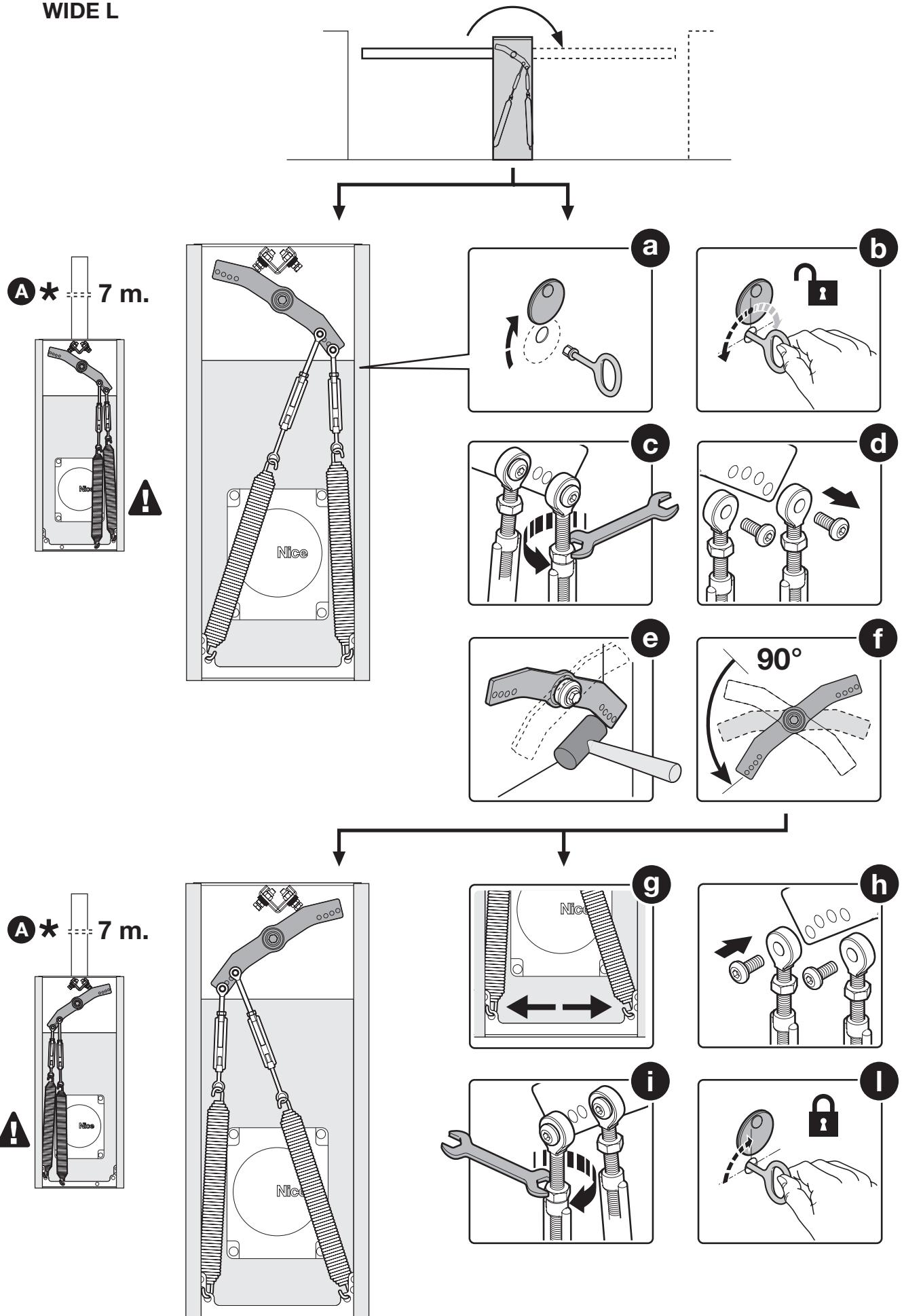
**A \*** Только в случае стрелы длиной 7 м установите балансировочные пружины так, как показано на рисунке «A»
