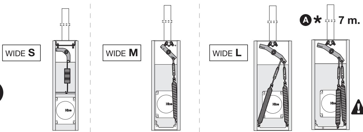
**⚠ \*** Только в случае стрелы длиной 7 м установите балансировочные пружины так, как показано на рисунке «A»
