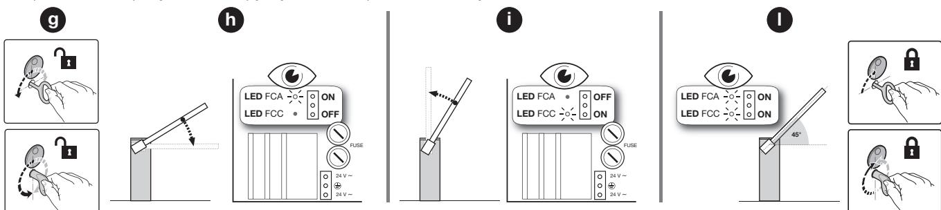
**Примечание - для наиболее оптимального использования функции замедления необходимо, чтобы концевой выключатель срабатывал за  $20^\circ$  до достижения механического стопора; при необходимости отрегулировать для этого положения обоих кулачков**
