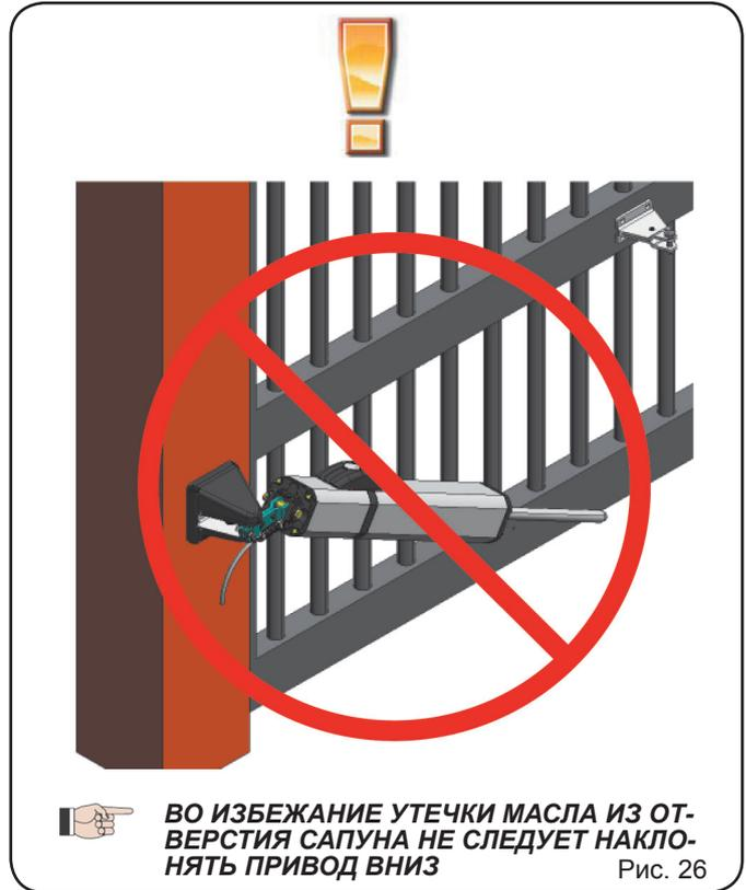
5. Наклоните привод вверх насколько это можно. Не следует при этом слишком сильно давить на задний кронштейн.
