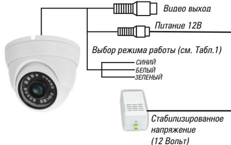
Рис.1 Схема подключения
