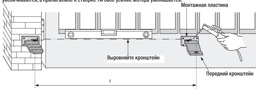
Закройте ворота и прикрепите к створке монтажную пластину, удостоверившись в том, что передний кронштейн расположен на одной горизонтальной оси с задним кронштейном, а также соблюдая расстояние Е.
