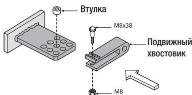
Прикрепите к столбу монтажную пластину с задним кронштейном (рис. 1), соблюдая расстояния А и В (таблица 3) между осью петли и центральным отверстием кронштейна. Задний кронштейн имеет несколько отверстий для регулировки угла открывания ворот.
