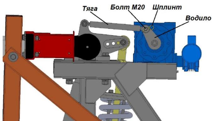
Шлагбаум выпускается с производства с расцепленным приводом от узла поворота стрелы
