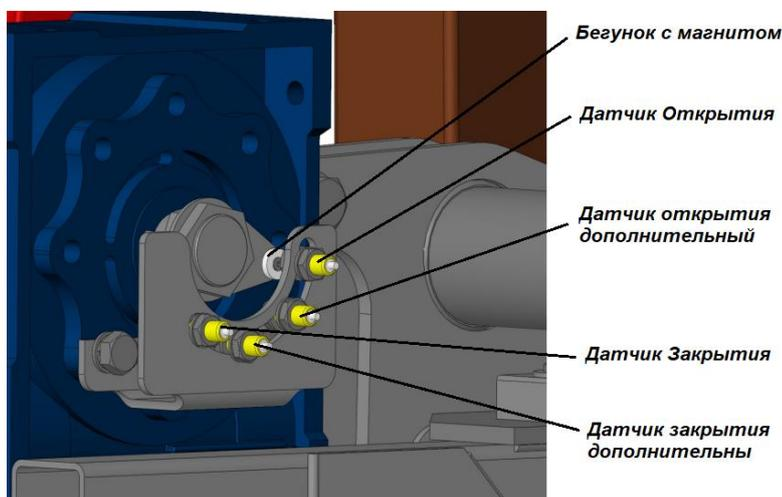
Датчики выполнены бесконтактными и имеют индикацию: при срабатывании на датчике загорается светодиод.
