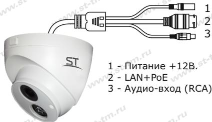
Рис.1 Схема подключения видеокamеры
