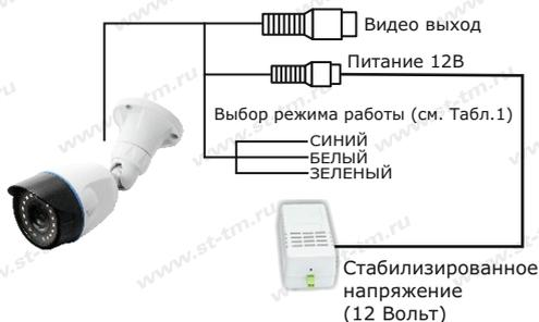
Рис.1 Схема подключения
