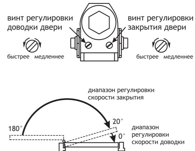
Закрытие и доводка регулируются 2 винтами. Сначала отрегулируйте скорость закрытия, далее скорость доводки двери. Обозначение регулировок винтов указаны на обратной стороне доводчика
