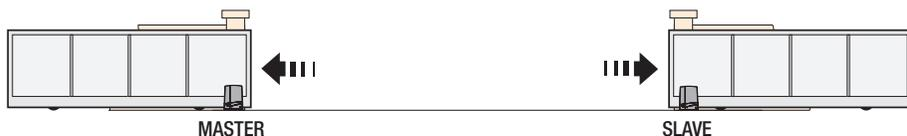
Режим «ЧАСТИЧНОЕ ОТКРЫВАНИЕ». Открывается створка привода MASTER до достижения точки частичного открытия, заданной в **[Установках хода]**.
