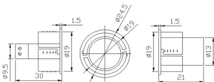
Извещатель магнитоконтактный ST-DM031NC-WT предназначен для контроля положения различных строительных конструкций (дверей, окон, люков, ворот и т.д.). Данное устройство может использоваться в системах охранной сигнализации или контроля и управления доступом.
