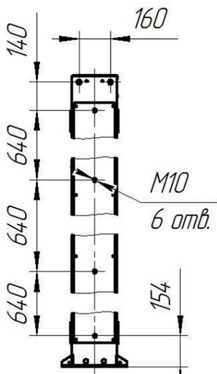
Размеры для подсоединения полноростовых ограждений «Ростов Дон» к турникету ПР1/М2 (вид на стойки 1 и 2 справа и слева)
