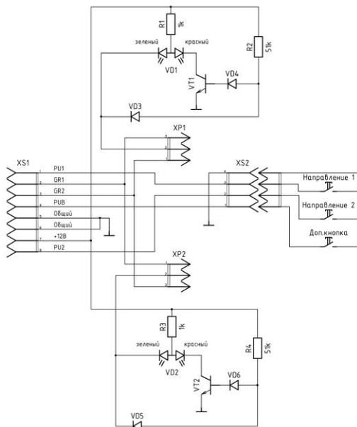
**Схема электрическая принципиальная
