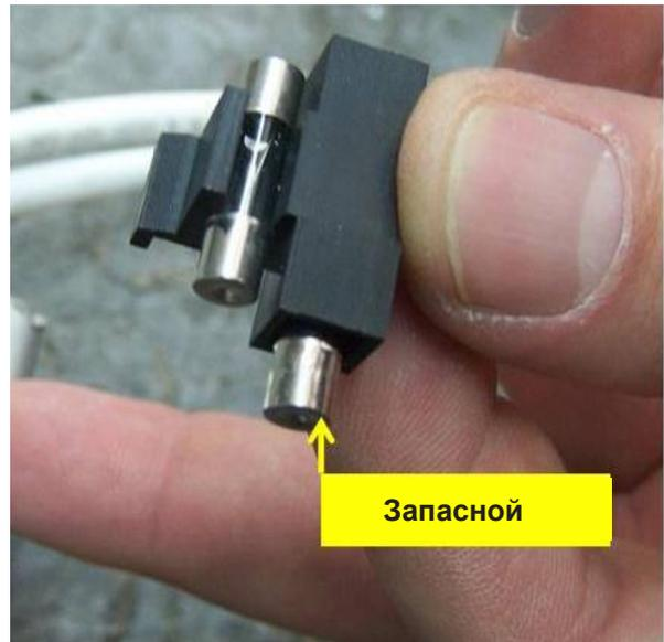
Рабочий и запасной предохранители расположены внутри сетевого разъема
