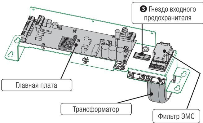
\* Предусмотрено для электроснабжения ~230 В. При сетевом электроснабжении ~120 В поменяйте местами провода 1 и 2 и замените входной предохранитель 3.
