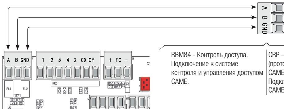
RBM84 - Контроль доступа. Подключение к системе контроля и управления доступом CAME.
