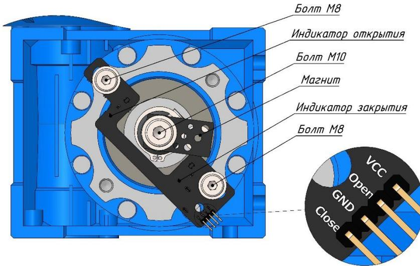
Выключатели выполнены бесконтактными на основе датчиков Холла. Концевые выключатели имеют индикацию: красный – ЗАКРЫТО, зеленый – ОТКРЫТО.
