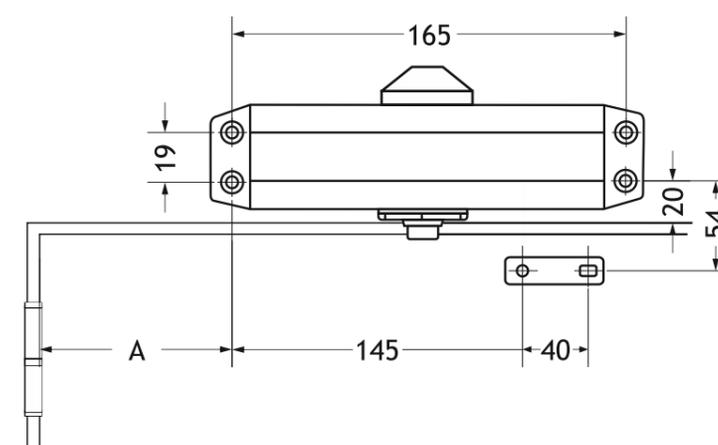
На чертеже показана дверь левого исполнения. Для двери правого исполнения используете зеркальное отображение чертежа с этими же размерами. Все размеры указаны в миллиметрах.
