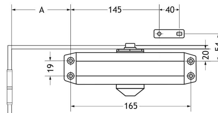
На чертеже показана дверь левого исполнения. Для двери правого исполнения используете зеркальное отображение чертежа с этими же размерами. Все размеры указаны в миллиметрах.
