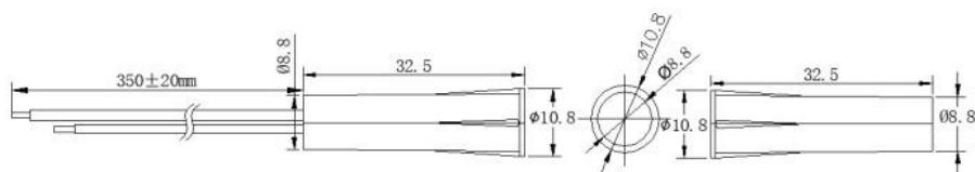
Извещатель магнитоконтактный ST-DM020NC-BR предназначен для контроля положения различных строительных конструкций (дверей, окон, люков, ворот и т.д.). Данное устройство может использоваться в системах охранной сигнализации или контроля и управления доступом.
