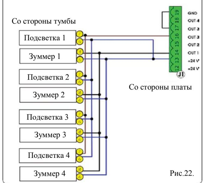
**Подключение 4-х концевых выключателей «ВНИЗ» параллельно. Тумбы выключаются, если срабатывают все 4 концевых переключателя.**
