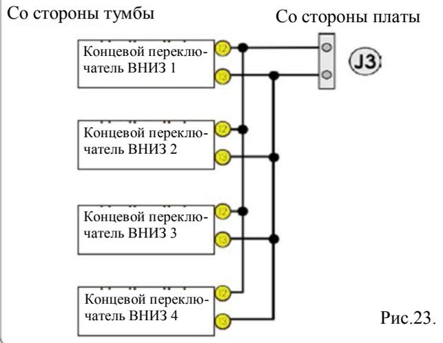
**Подключение 4-х концевых выключателей «ВВЕРХ» параллельно. Тумбы выключаются, если срабатывают все 4 концевых переключателя.**
