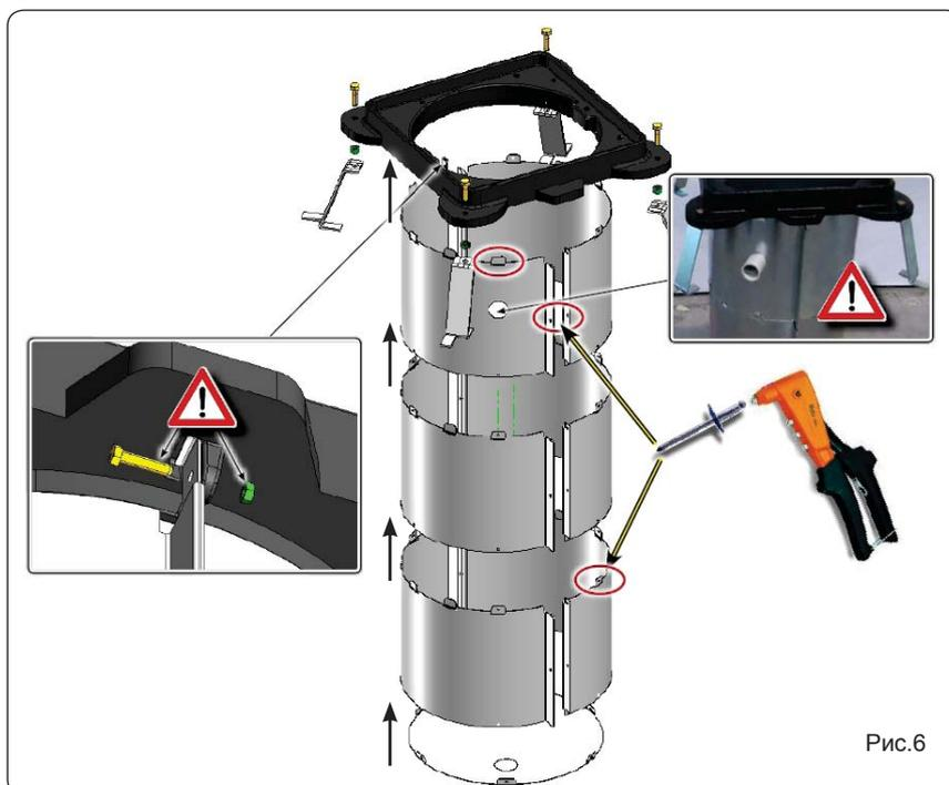
**!** Закрепите металлический кожух (шахту), как показано на рисунке с помощью поставленных в комплекте заклепок и прикрепите его к опорной раме двумя винтами и соответствующими болтами, входящими в состав комплекта поставки. При сборке и креплении кожуха к опорной раме соблюдайте дополнительные инструкции, поставляемые с кожухом и опорной рамой.
