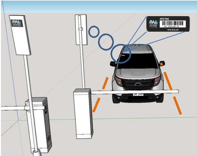
Номер метки считывается излучающей антенной на расстоянии от 3 до 12 метров.
