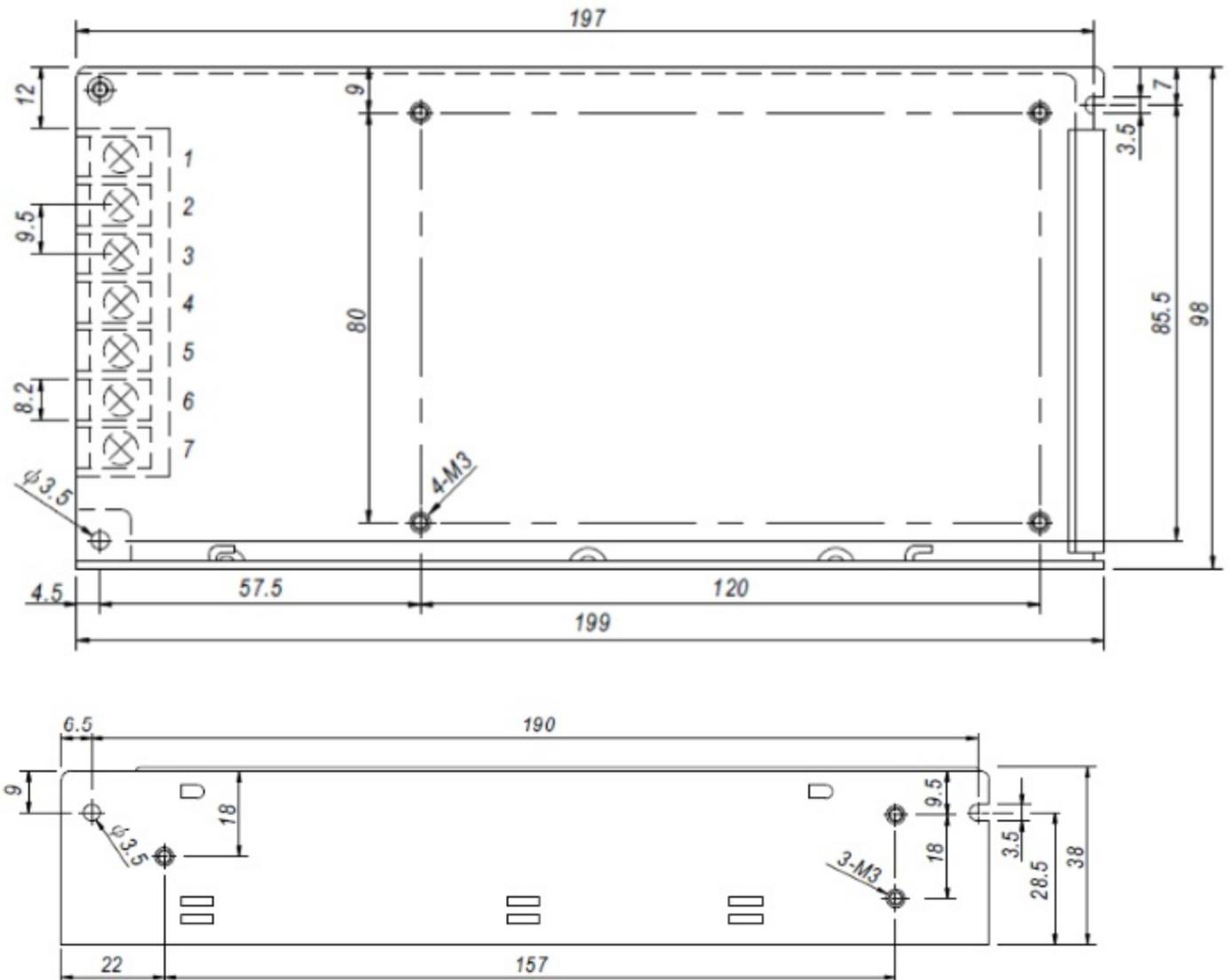
Размеры корпусов 240W/12V и 350W/48V
