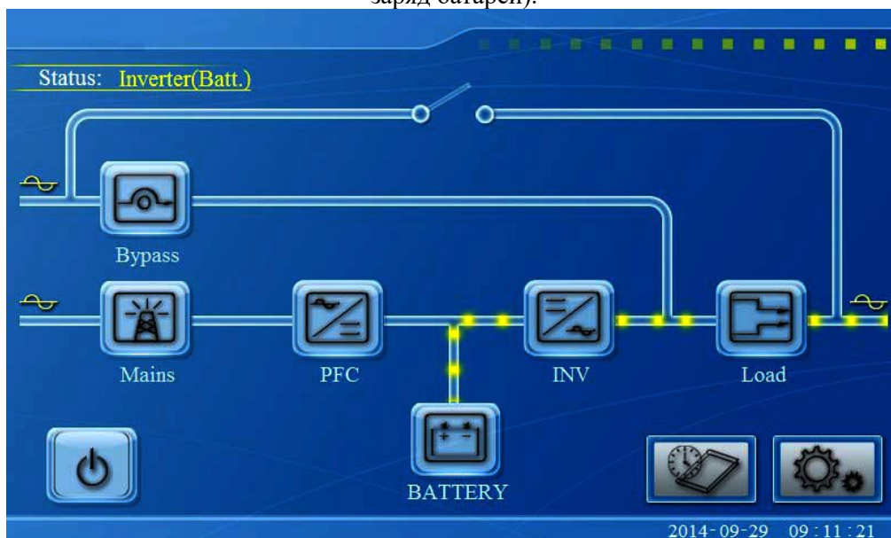
Рис.6.5 Режим работы от батарей (входное напряжение отсутствует, нагрузка защищена Инвертором от энергии батарей).
