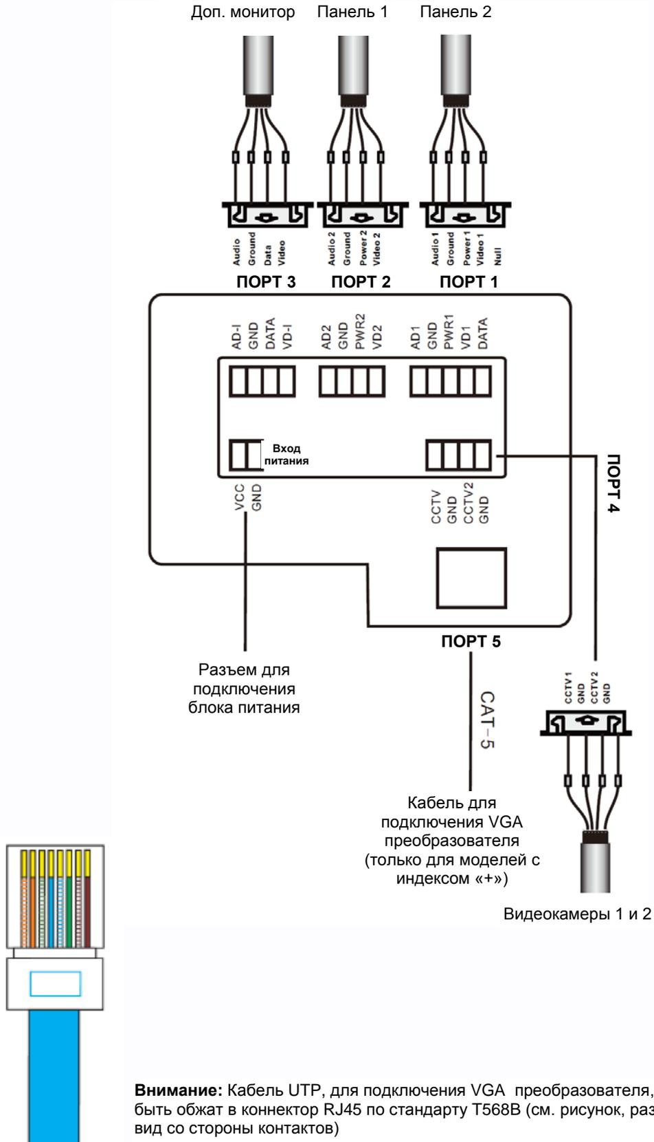
**Внимание:** Кабель UTP, для подключения VGA преобразователя, должен быть обжат в коннектор RJ45 по стандарту T568B (см. рисунок, разъем RJ45, вид со стороны контактов)
