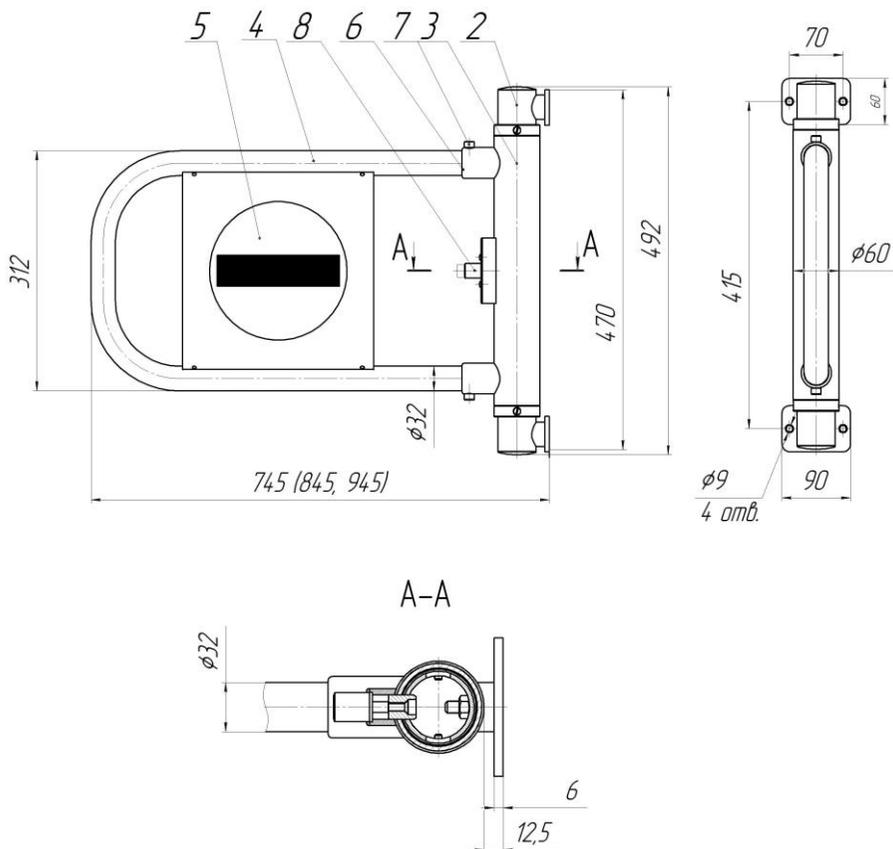
Габаритные и установочные размеры калитки K52K
